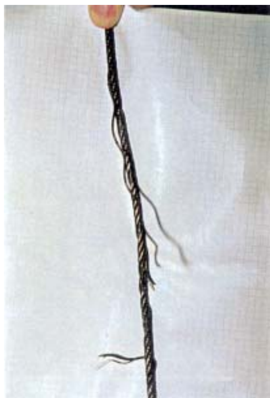
Cavo del verricello con rotture die singoli fili. In totale il cavo stesso presentava 10 rotture, più o meno pronunciate.
