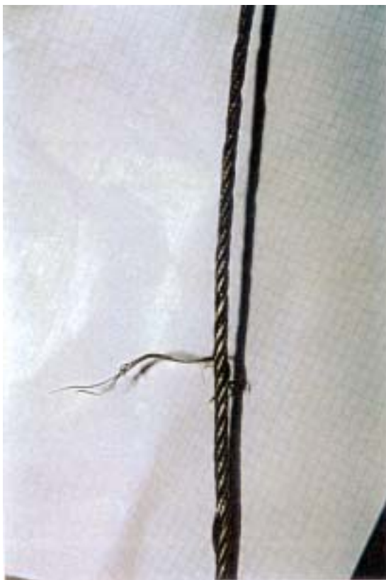
Cavo del verricello con rotture die singoli fili. In totale il cavo stesso presentava 10 rotture, più o meno pronunciate.
